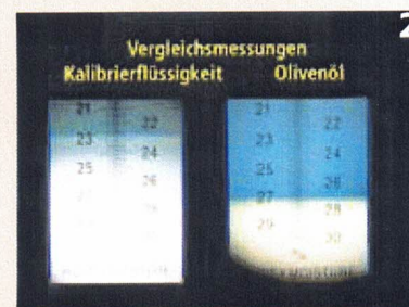
2 Beim Test in der Redaktion zeigte das mit der Kalibrierflüssigkeit eingestellte Refraktometer mit Olivenöl einen beständigen Wert von 27,1 % Wassergehalt an. Fotos: Autor
